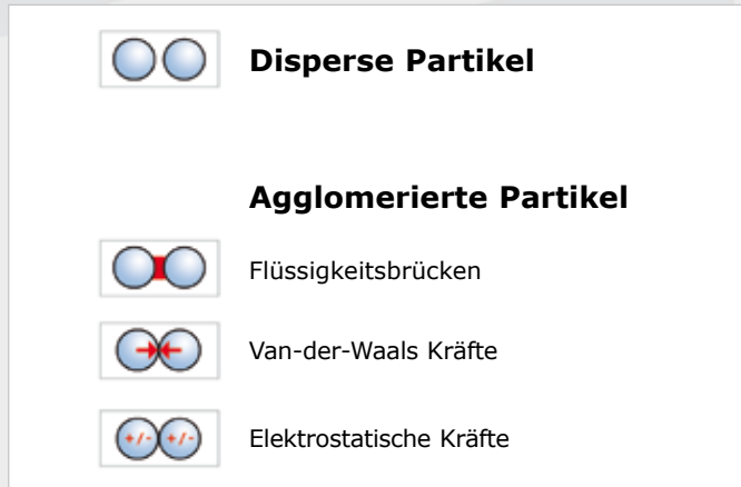
Abb. 7: Haftkräfte zwischen Partikeln, die das Siebergebnis beeinträchtigen können
