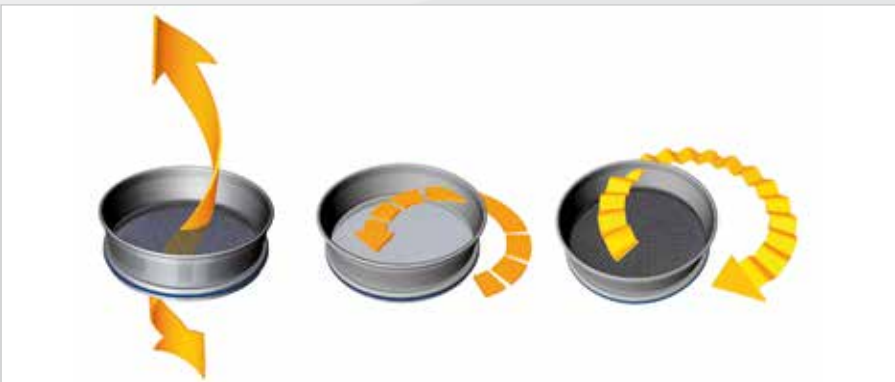
Abb. 2: Prinzip der Wurfsiebung (links), Plansiebung (Mitte) und Klopf siebung (rechts).
